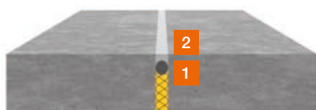
Vertikale/horizontale Fuge nicht befahrbar
